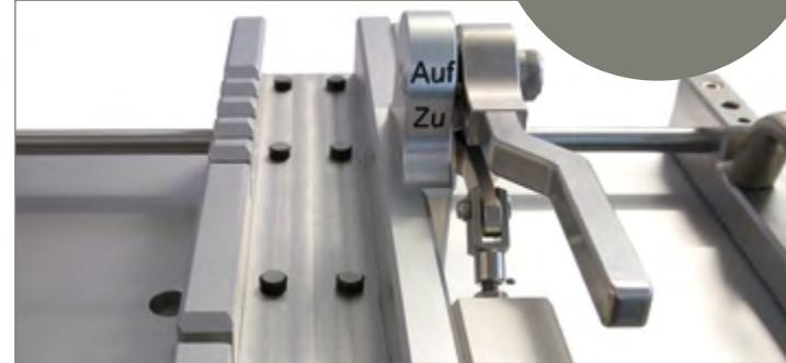
**Variable Auslegung:** Die Vorrichtung ist für das gleichzeitige Bearbeiten von sieben Nägeln ausgelegt. Sie ist für > 500 Nagelkonfigurationen ausgelegt. Für diese verschiedenen Typen gibt es fünf Modulblöcke, die paarweise Anwendung finden. Die Marknägel unterscheiden sich in Länge, Durchmesser, Krümmung und Schaftaufnahme.
