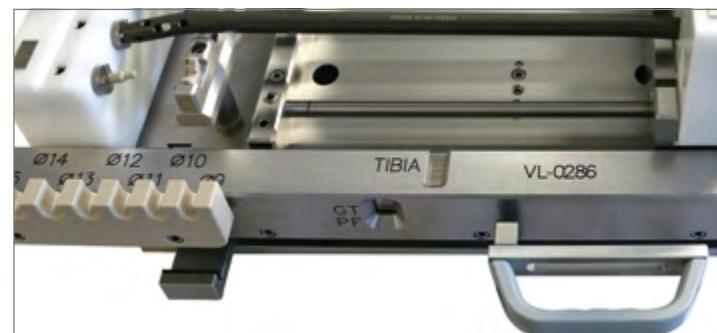
**Ergonomisch optimiert:** Die Ausziehvorrichtung / der Maschinenauszug ist einhändig bedienbar, hat eine Anschlagvorrichtung und ermöglicht somit eine ergonomische Körperhaltung beim Bestücken der Anlage.
